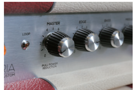
▲こちらのモデルもプル・パワー・リダクション機能を装備。出力を下げても、音質の変化が少ないのはうれしい
