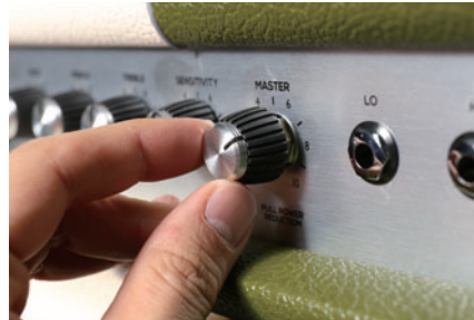
▲マスター・ボリュームを引っ張ることで、出力が30wから5wになるプル・パワー・リダクションという機能を搭載
