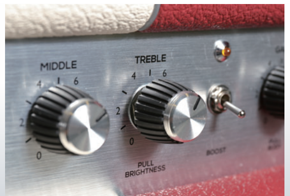
▲トレブルを引くことで、ブライトネスというコントロールが作動する。オンにすることで、4kHzより上の範囲が+6dBブーストしてくれる
