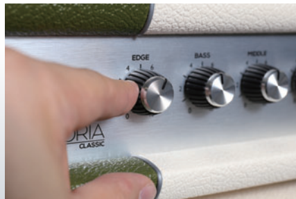
▲エッジというトーン・コントロールは、プリ段にかかりアンプ全体的な明るさを調整してくれる
