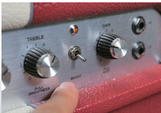
▲ゲイン量を20%アップさせるブースト・スイッチ。オンにすると上のLEDが点灯する。別売りのフット・スイッチでの切り替えも可能だ
