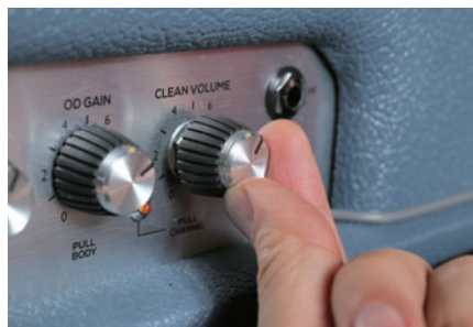
▲クリーン・ボリュームのつまみには、チャンネル切り替え機能も搭載している。プルすると切り替わる
