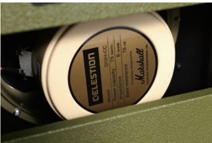
▲スピーカーは、コンボ、スタック共通で、セレッション製の12インチを採用している
