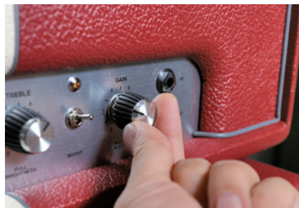
▲プリ部の歪みを調整するゲイン・コントロール。プルすることで、モダンなハイ・ゲイン・サウンドになる
